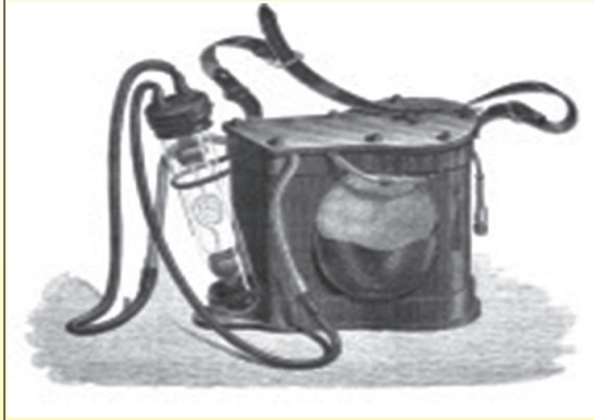
1862年Dumas et Benoit的电矿工灯
